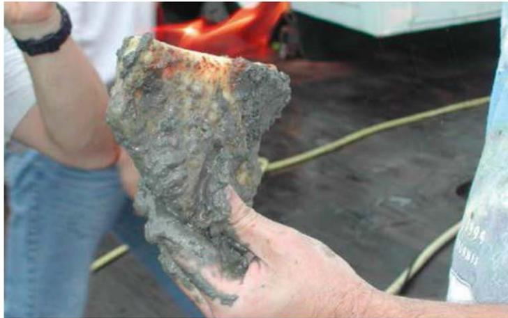
**Figure 2.6** – Échantillon de sédiment marin contenant des hydrates de gaz auquel on a mis le feu. La dissociation de l'hydrate à température et pression atmosphérique libère les gaz jusque-là emprisonnés qui peuvent alors brûler.
