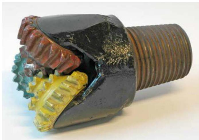
**Figure 8.2** – Exemple de trépan pour forage pétrolier. Cliché Alexandre Lethiers.
