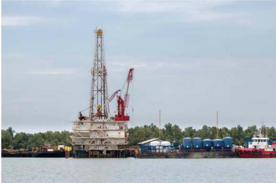
**Figure 8.5** – Exemple de *swamp barge* en zone très peu profonde ou dite *de transition* (il faut parfois percer un chenal pour acheminer l'appareil au point d'implantation ou envisager un forage dévié). Document Total.
