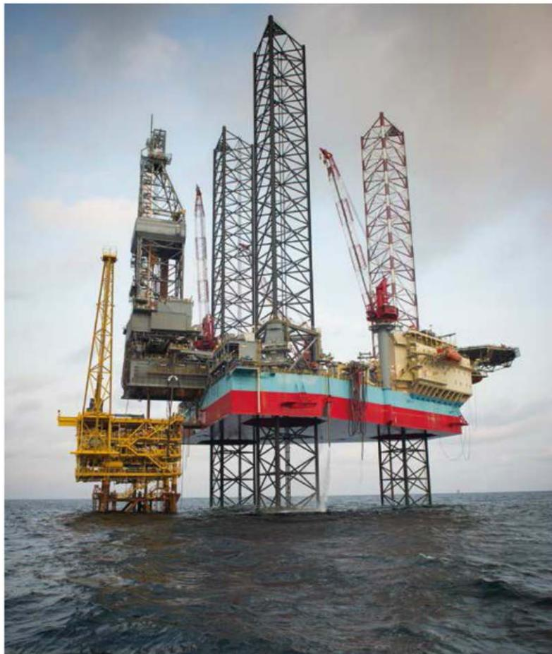
**Figure 8.6** – Exemple de *jack up* (plateforme auto-élevatrice). Document Total. Ici la plateforme est positionnée à côté d'une installation de production, elle travaille sur un forage existant.
