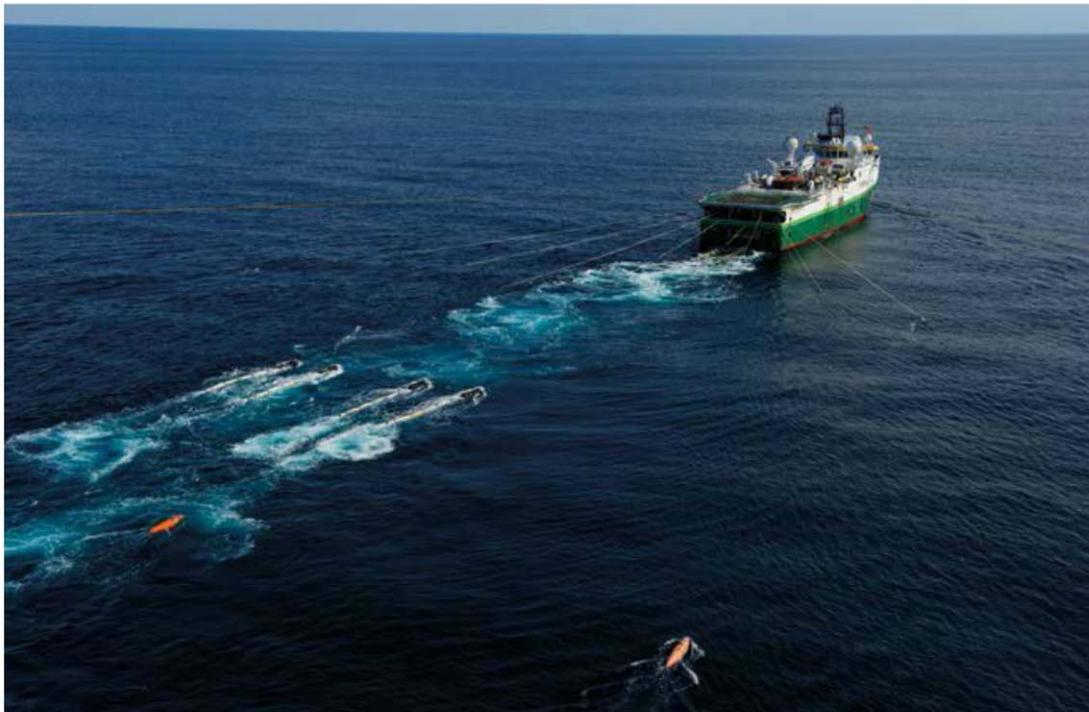
**Figure 8.16** – Exemple d'une acquisition sismique marine avec un bateau multi-streamers. Document Total.
