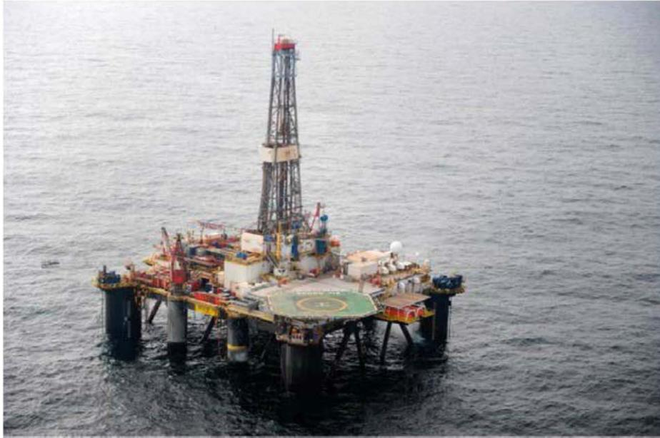
Figure 8.7 – Exemple de plateforme semi-submersible. Document Total.
